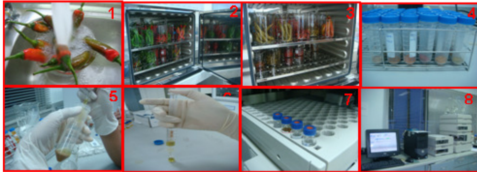
ภาพที่ 1 ขั้นตอนการเตรียมตัวอย่างและวิเคราะห์สารกลุ่ม capsaicinoids ด้วยเครื่อง HPLC
